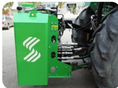
Central hidráulica trasera para recolectores delanteros.
