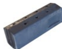
Sustitución mazos de serie por mazos duros montados
